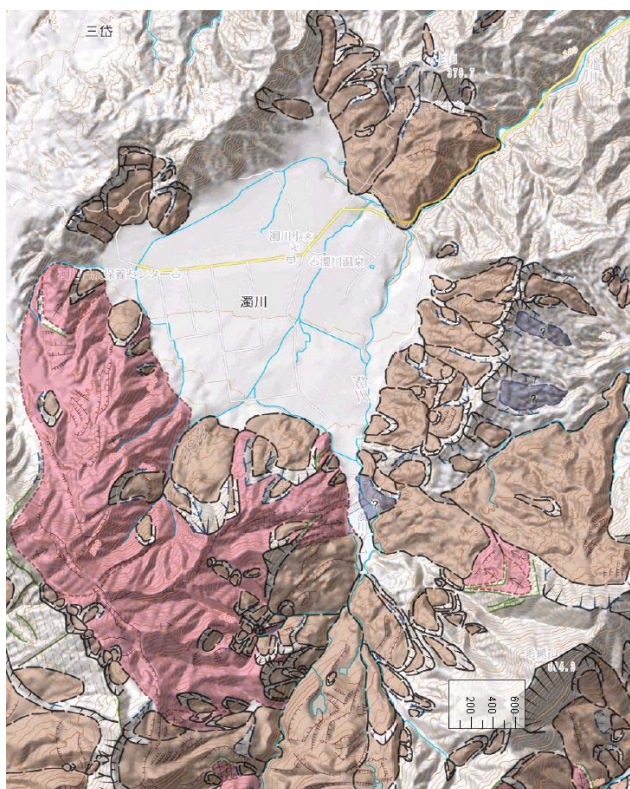
図 2 濁川カルデラ周辺の地すべり地形(カルデラの南西側に初期的斜面変形が広く分布している)
