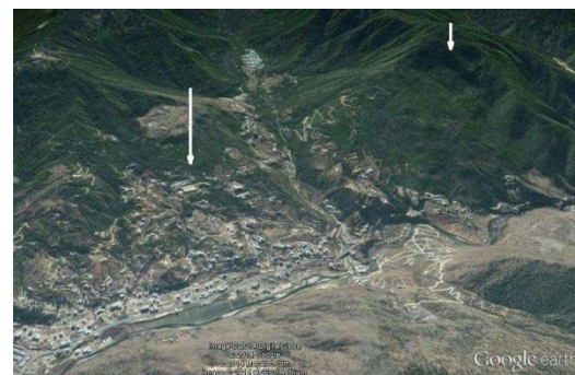
写真 8. 地すべりのような地形 (Google earth より) (↓の周囲：現状で動きは確認されていない)
