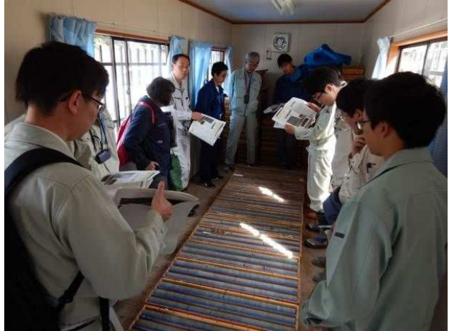
写真-3 ボーリングコアですべり面付近の地質性状を確認
