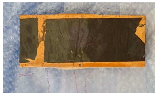
写真-3 想定すべり面の半割コア
