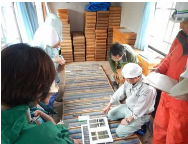
写真-2 岩盤すべりにおけるすべり面観察の様子 岩盤すべり移動土塊のすべり面を貫くボーリングコアを観察した。合計で5本のボーリングコア（総延長345m）を観察した。
