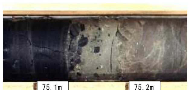
写真-5 日高幌内川岩盤地すべりのすべり面付近のボーリングコア (5.1 早川・戸田ほか)
