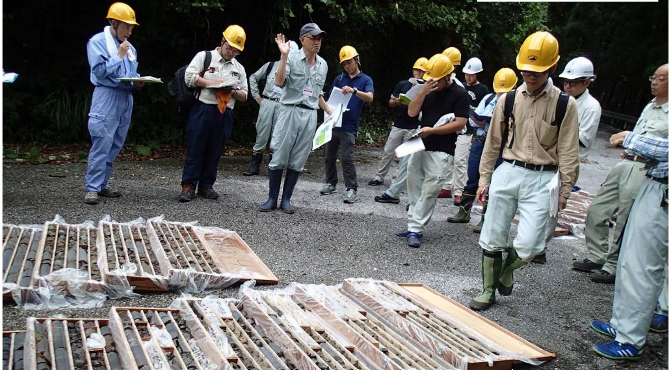
ボーリングコアの観察 ボーリング地点でのすべり面深度を推定
